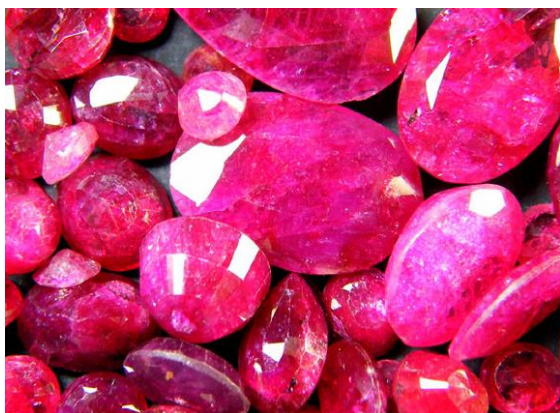
شکل ۴: یاقوت های بهسازی گرمایی ساده شده و قبل از فرایند بهسازی با شیشه سرب دار
