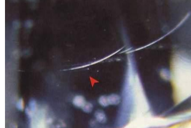
شکل ۱۳: حفره پریدگی های بسیار ریز بر روی سطح سنگ
