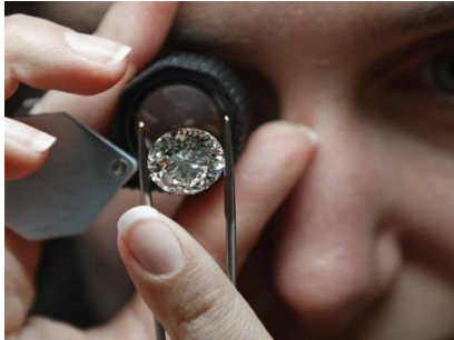
شکل ۲۱: آناتومی درست برای مشاهده ناخالصی ها توسط لوپ و پنس گوهرشناسی
