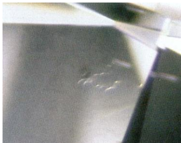
شکل ۶: نمایی از ناخالصی بافت مرکزی Grain center inclusion
