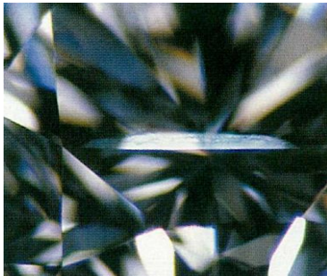
شکل ۷: نمایی از ناخالصی بافت مرکزی Grain center inclusion
