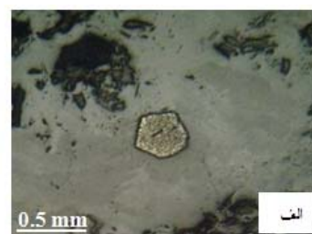
شکل ۵: الف) پیریت‌هایی که همزمان با مگنتیت تشکیل شده‌اند ب) پیریتی که در فاز سولفیدی پس از تشکیل مگنتیت به وجود آمده است ج) پیریت مگنتیت را محصور کرده است و نشان از آن دارد که سولفید بعداً وارد شده و یک فاز متأخر می‌باشد
